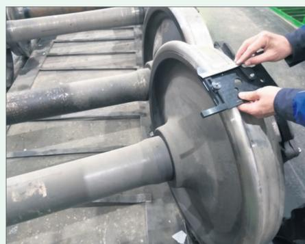
Обычно ремонт колёсных пар производится на вагонных заводах, в депо, мастерских. Но на Коршунновском ГОКе в составе РЭМЦ есть собственный колёсный участок. Именно здесь решают проблему восстановления дорогостоящих колёсных пар-тонкомеров: вместо списания в металлолом им
